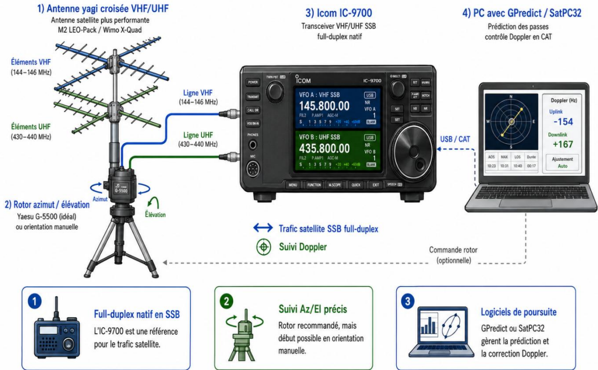
Figure 14 - Station SSB satellite avec IC-9700, rotor Az/EI et PC.
