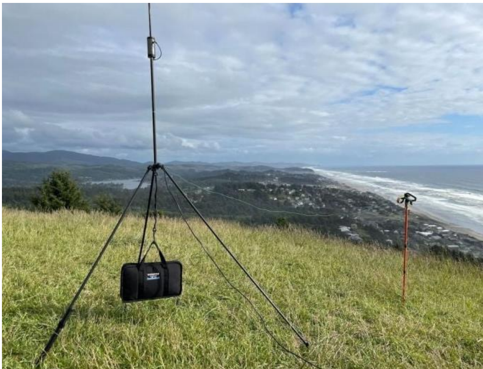
Figure 13 — Buddistick PRO : déploiement terrain en verticale portable (photo distributeur).
