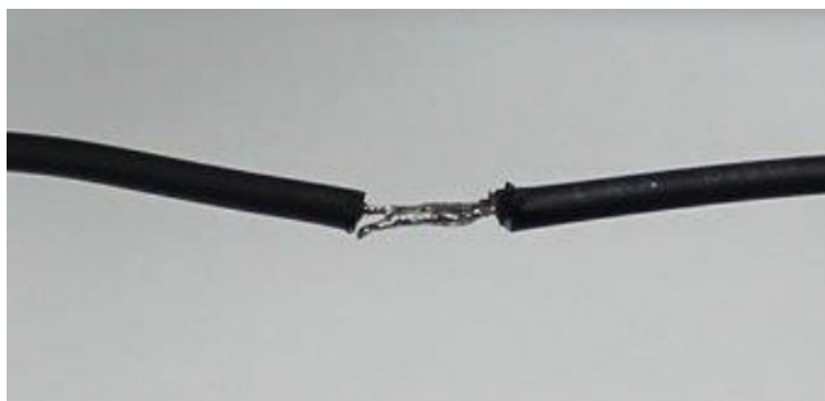
De twee vertinde draden samen verhitten.
