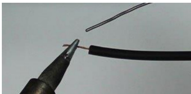
Kort opwarmen zonder de isolatie te beschadigen.
